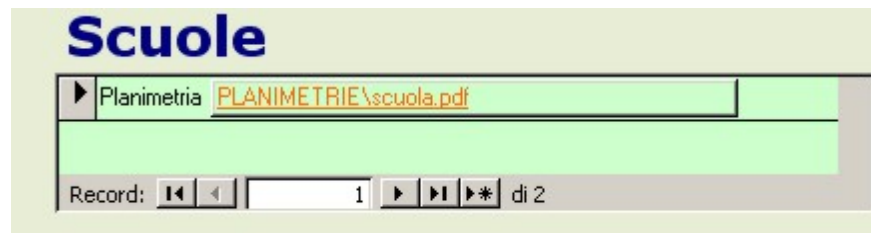
Figura 2-1: Esempio di maschera dove inserire le planimetrie. Si noti il nome del file completo di estensione e l'indicazione del percorso per poterlo. Dovrà inoltre esserci corrispondenza tra il nome del file e quello inserito nel record.
