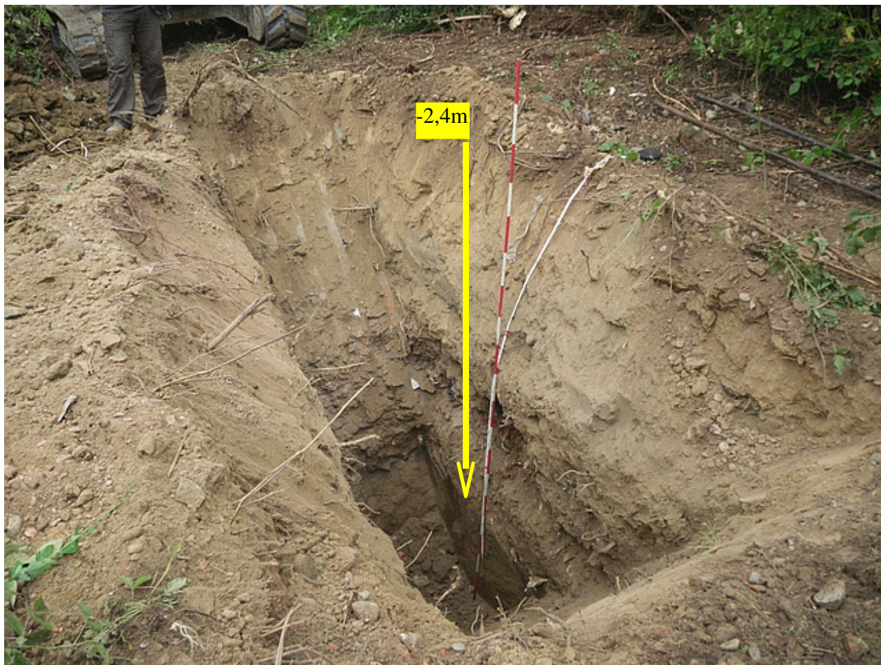
Illustrazione 23 Punto di campionamento baricentrico a edificio residenziale, pozzetto di prelievo
