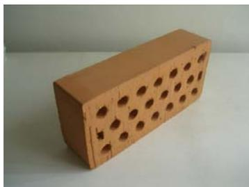
Figura 19.2 - Esempio di mattone semipieno  $15\% < \leq 45\%$  in laterizio per murature portanti<sup>2</sup>
