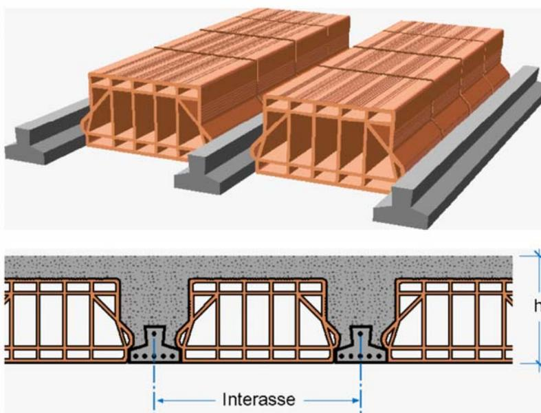
Figura 22.3 - Esempio di solaio in cemento armato a travetti in cemento armato e blocchi interposti<sup>5</sup>
