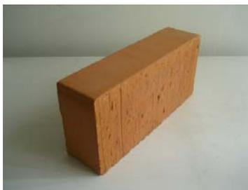
Figura 19.1 - Esempio di mattone pieno  $\leq 15\%$  in laterizio per murature portanti<sup>1</sup>
